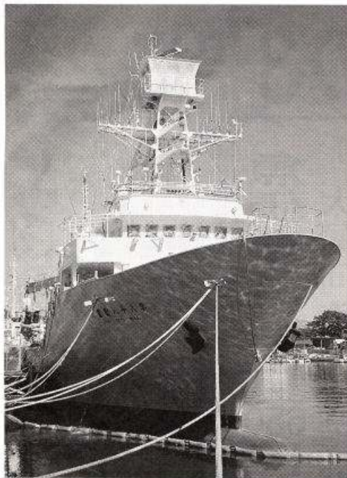
船首側から見た第88惣寶丸。大きなバルバスパウ、前部にまとめられた居住区が特徴 (写真はいずれも工事中のもの)
