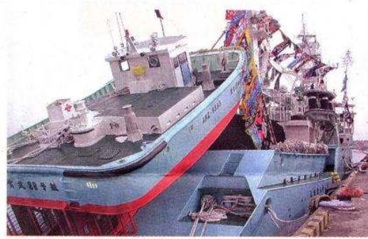
スリップウエーに搭載するスキフボート
